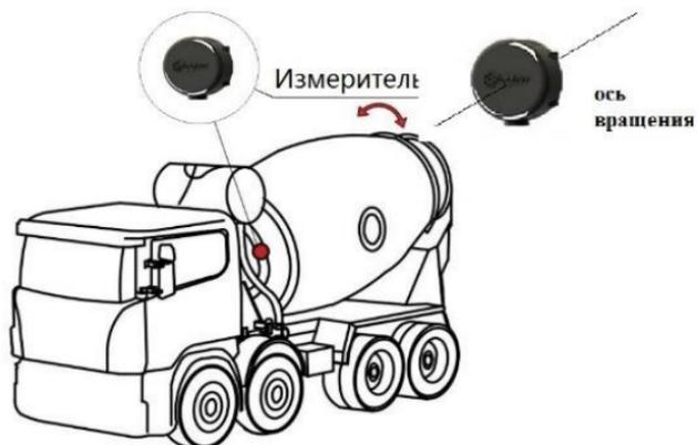
Рис.1. Размещение DU-BLE на бетоносмесителе в режиме вертикального вращения.
