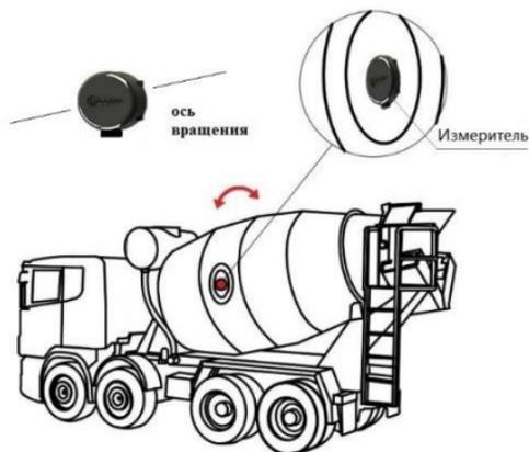
Рис.2. Размещение DU-BLE на бетономесителе в режиме горизонтального вращения.
