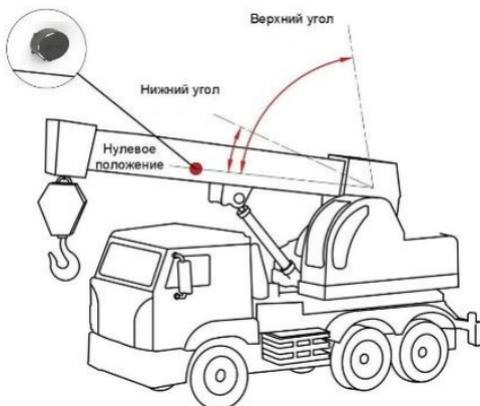
Рис.4. Размещение датчика DU-BLE в режиме угла.
