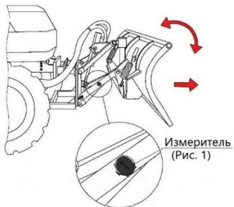
Рис.6. Установка датчика DU-BLE на устройства типа «отвал»
