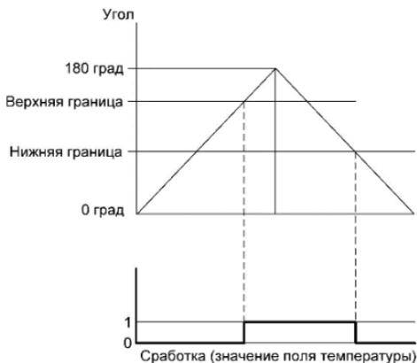
Рис.3. Принцип работы датчика в режиме контроля угла.
